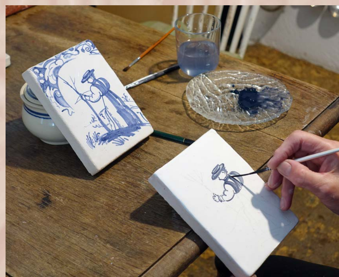
Postup při výrobě rokokového kachle malovaného kobaltem, malba kobaltem do syrové glazury podle vzoru (vlevo), malovaný vzorek po vypálu (vpravo)
